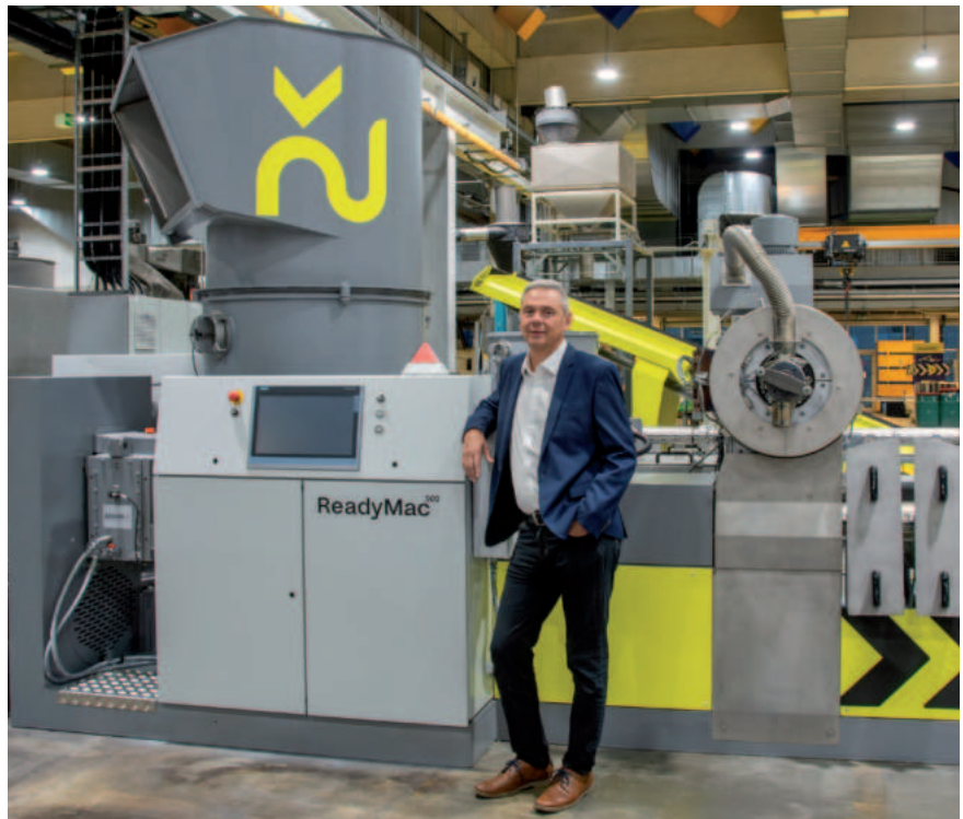
EREMA公司ReadyMac 业务部负责人Michael Köhnhofer对产品的成功感到欣喜。现货供应的回收机提供两个版本：配备激光过滤器或配备SW RTF®换网器系统。 (图片来源：EREMA)
