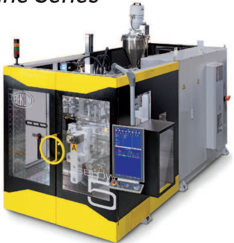
SBLOW 5S型单工位挤出型吹塑机, 锁模力为50千牛, 也可选择双工位机型。(图片来源: Bekum)
